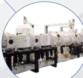
Линии непрерывного действия и вакуумные установки периодического действия для нанесения покрытий на **объемные штучные изделия** магнетронным распылением. Область применения: коррозионно-стойкие, защитно-декоративные и экранирующие покрытия.
