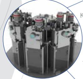
Кластерная вакуумная установка для нанесения покрытий на **плоские подложки из различных материалов**. Модульная система, обеспечивающая подключение до 5-ти процессорных камер и комбинирование различных источников нанесения покрытий. Область применения: НИР в области вакуумных тонкопленочных технологий.
