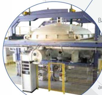
Вакуумные установки периодического действия для нанесения покрытий на **крупногабаритные объемные оптические детали** магнетронным распылением. Область применения: многофункциональная астрономическая оптика.
