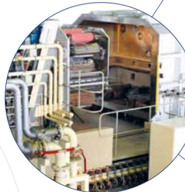
Вакуумные установки периодического действия для нанесения покрытий на **металлические рулонные материалы** электронно-лучевым испарением, магнетронным распылением, и термическим испарением. Область применения: анодные материалы для батарей, солнечные элементы, антикоррозионные покрытия и катализаторы.
