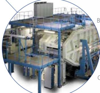
Вакуумные установки периодического действия для нанесения покрытий на **металлические рулонные материалы** посредством плазмохимического осаждения из газовой фазы. Покрытие в виде многослойных p-i-n структур формируется в среде реакционных и допирующих газов под воздействием радиочастотного разряда. Область применения: солнечные элементы.
