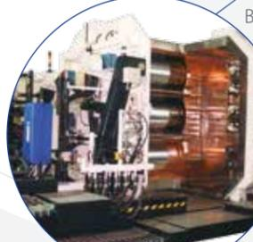
Вакуумные установки периодического действия для нанесения покрытий на **полимерные пленки, бумагу и металлические фольги** магнетронным распылением и термическим испарением. Область применения: солнечные элементы, сенсорные панели, ЖК экраны, гибкие печатные платы и конденсаторы.
