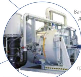
Вакуумные установки периодического действия для нанесения покрытий на **дисперсные материалы** магнетронным распылением и термическим испарением. Область применения: солнечные элементы, электрическое оборудование, алмазно-абразивные инструменты, порошковая и гранулярная металлургия.
