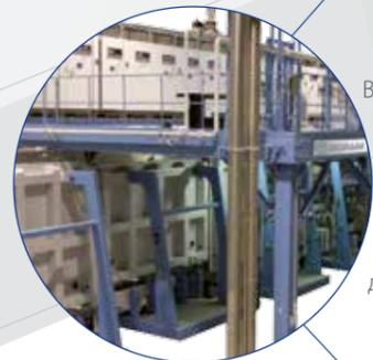
Вертикальные и горизонтальные линии непрерывного действия и вакуумные установки периодического действия для нанесения многослойных покрытий на **крупногабаритное листовое стекло** скоростным магнетронным распылением. Область применения: солнечные элементы, дисплеи, стекла для теплиц, зеркала и арт-стекла.
